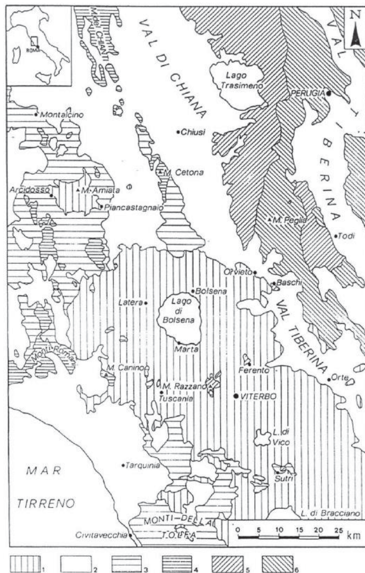
Figura 54 - Carta geologica schematica della Toscana sud – orientale, Umbria occidentale e alto Lazio. Legenda: 1) Vulcaniti quaternarie; 2) Depositi post – orogenici neogenici e quaternari; 3) Liguridi s.l. (Cretaceo – Oligocene); 4) Serie Toscana (pre Trias – Miocene Inferiore); 5) Unità Cervarola Falterona (Cretaceo sup. – Eocene/Serravalliano) 6) Serie Umbra (Trias. Sup – Miocene medio – sup.)
