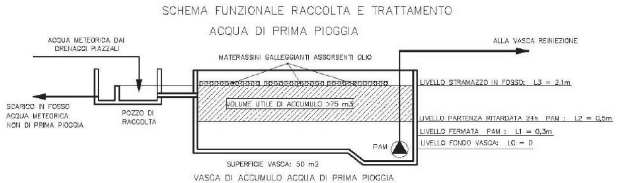
Figura 34- Schema funzionale raccolta e trattamento acqua di prima pioggia parte GEO.
